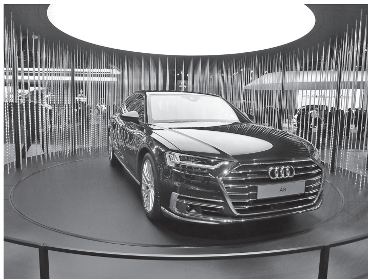
アウディの最新セダン「A8」：ナンバープレート下部にLiDARを搭載している
