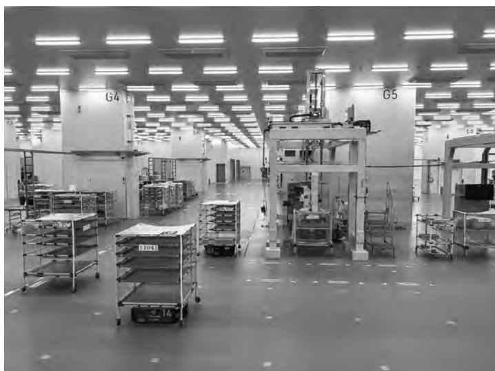
新製造棟の2階にあるクラス1万レベルのクリーンルーム
